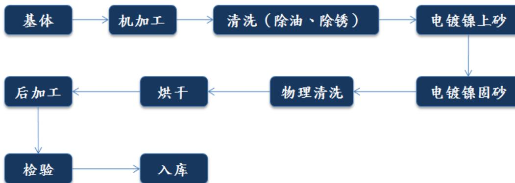
(3) 公司陶瓷结合剂金刚石砂轮的生产流程如下图所示：
