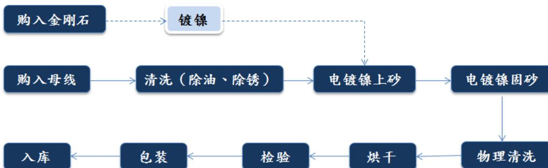
注：发货前根据不同客户的需要，金刚线还需经复绕、开刃等后处理工序
